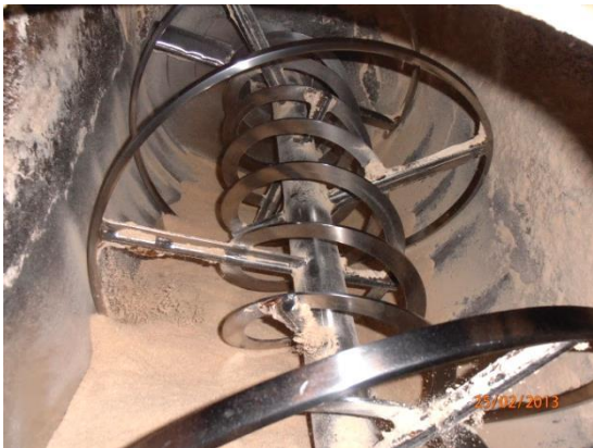
Foto 3. Belægninger i blanderen var ikke noget problem i den korte - og kolde- testperiode.
