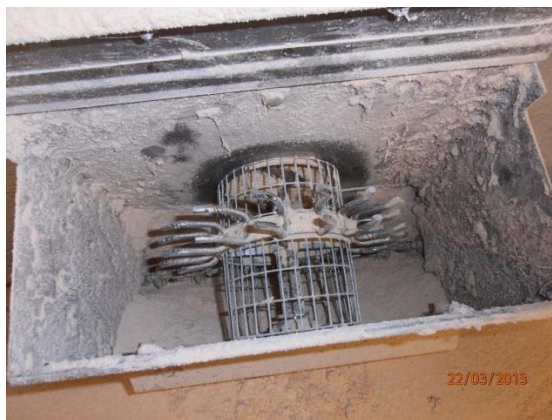
Foto 5. Påslag med stålfigre og cylindrisk sigte fra Aza International var sandsynligvis medvirkende til at overgangen fra færdigfodersilo til foderstreng gik fint med foder iblandet op til 20 % ensileret kernemajs.
