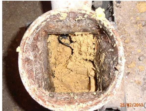
Foto 2. Snegletransport af den våde, ensilerede kernemajs var ikke muligt.
